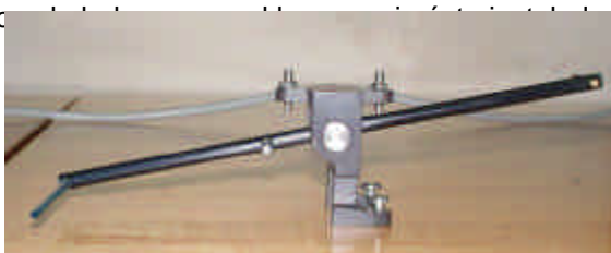
Brazo indicador del nivel de flotación desmontado.
