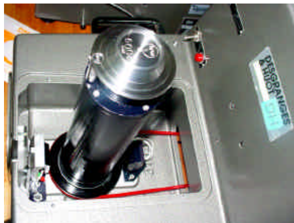
Poste de montaje del pistón cilindro con banda del motor colocada.
